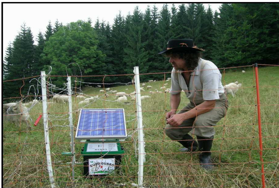
7. Kontrola solárního zdroje a funkčnost elektrického ohradníku (u chovatele J. Kocurka)
